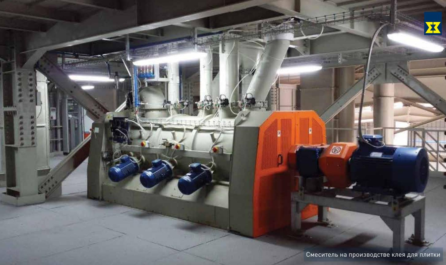
Смеситель на производстве клея для плитки
