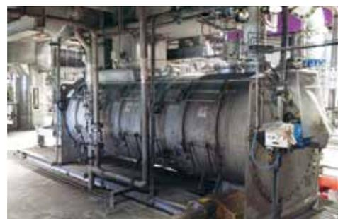
Опция выгрузки через фронтальную панель с ножевой задвижкой, позволяет плавно изменять уровень материала внутри смесительной камеры, даже во время работы. Таким образом, время смешивания можно увеличить или уменьшить, чтобы оптимизировать качество смеси.
