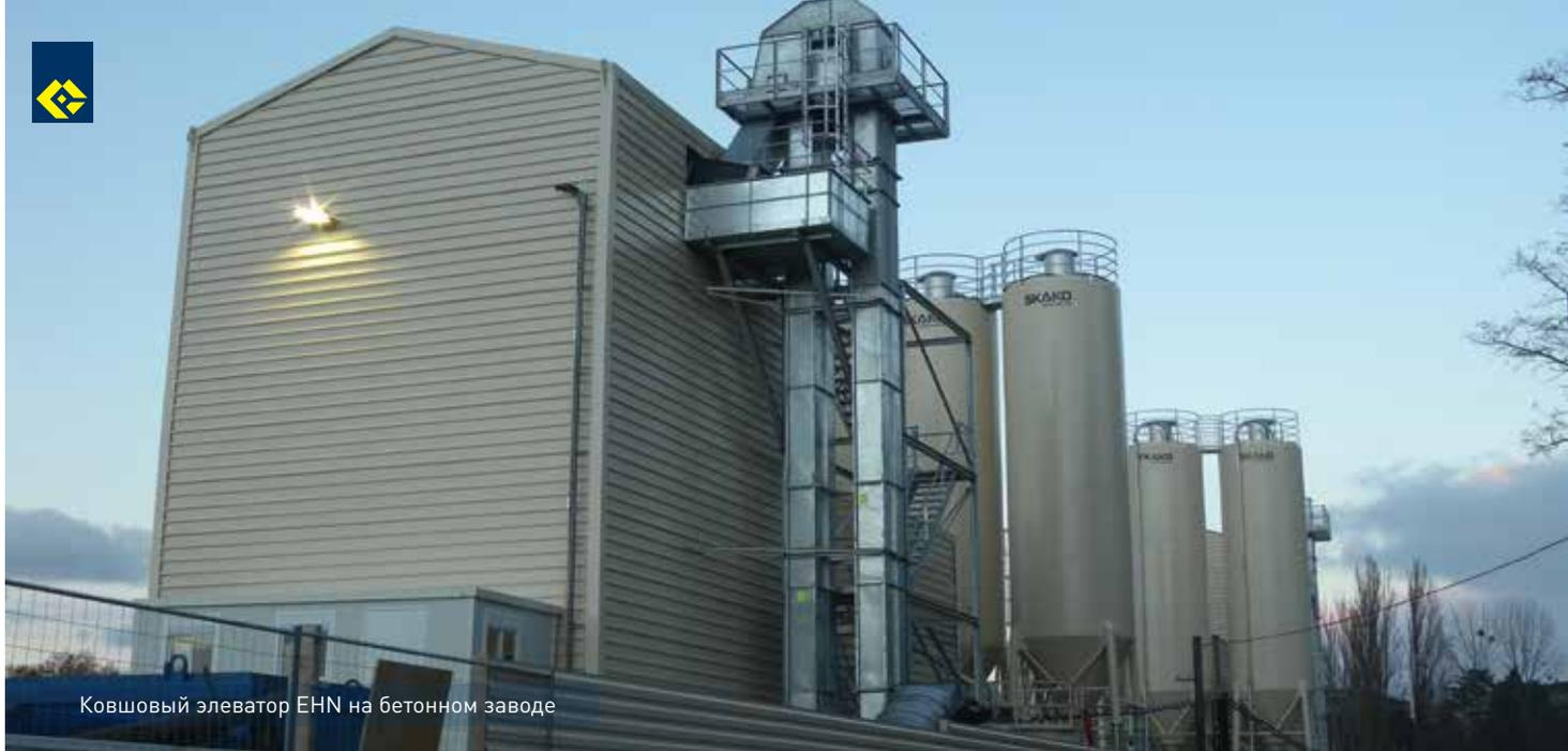
Ковшовый элеватор ЕНН на бетонном заводе
