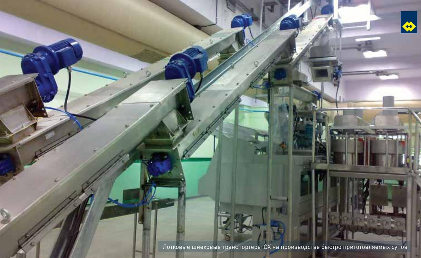
Лотковые шнековые транспортеры СХ на производстве быстроготавливаемых супов
