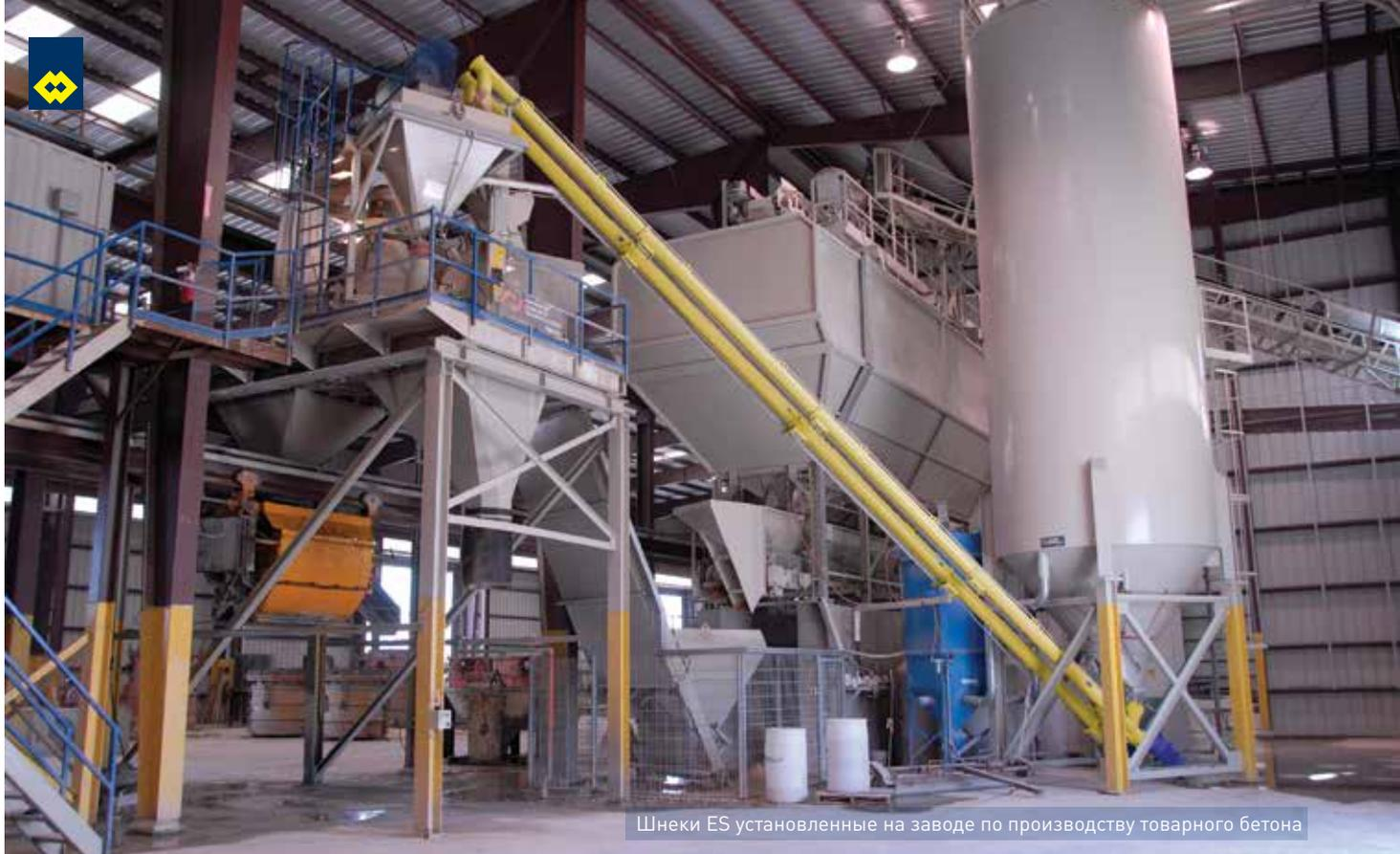
Шнеки ES установленные на заводе по производству товарного бетона
